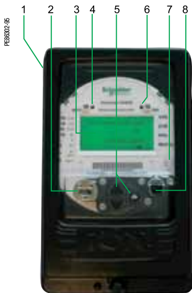
PowerLogic ION8650 в щитке
